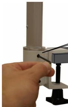
Oberen Gewindestift (M6x6) festdrehen, so dass das Fußende des Tragarms fest gegen die Hülse der Tischhalterung gepresst wird.
